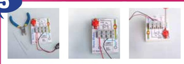
Mini-Taster mit der Lüsterklemmenleiste verbinden. Danach die Drähte festschrauben. Beim Taster die Drähte vorher um die noch lockeren Schrauben wickeln.
