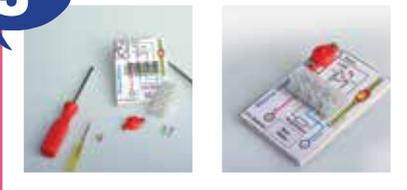
Jetzt werden der Mini-Taster und die Lüsterklemmenleiste an die im Schaltplan angegebenen Stellen geschraubt. Auch hier die Schraubstellen vorher mit der Stechahle „anpieken“. Beim Taster dürfen die Schrauben noch nicht fest angezogen werden.
