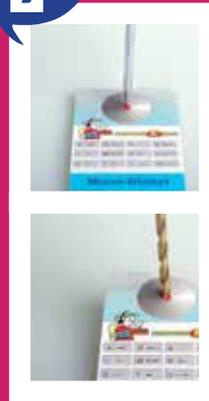
Bohrt genau im Mittelpunkt des auf dem Frontbild befindlichen Kreises vorsichtig ein 5 mm-Loch. Dort wird später die Leuchtdiode durchgesteckt. Um den Mittelpunkt beim Bohren genau zu treffen, solltet ihr ihn vorher mit der Stechahle „anpieken“.
