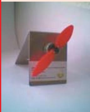
Dieser Tischventilator benötigt die Kraft der Sonne, um für frischen Wind zu sorgen. Ihre Strahlen werden von den Solarzellen aufgenommen und direkt in elektrische Energie umgewandelt. Diese reicht aus, um einen kleinen Elektromotor anzutreiben, der ein Flügelrad zum Drehen bringt.
