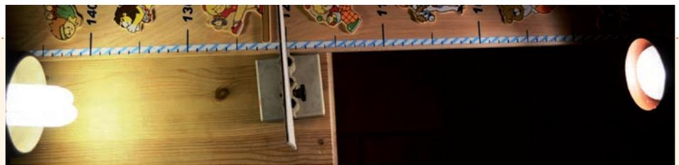
Mit nur geringem Aufwand kann man die Helligkeit einer Glühlampe und einer Energiesparlampe miteinander vergleichen. So entspricht die Leuchtstärke einer 7-Watt-Energiesparlampe in etwa der einer Glühlampe von 35 Watt.
